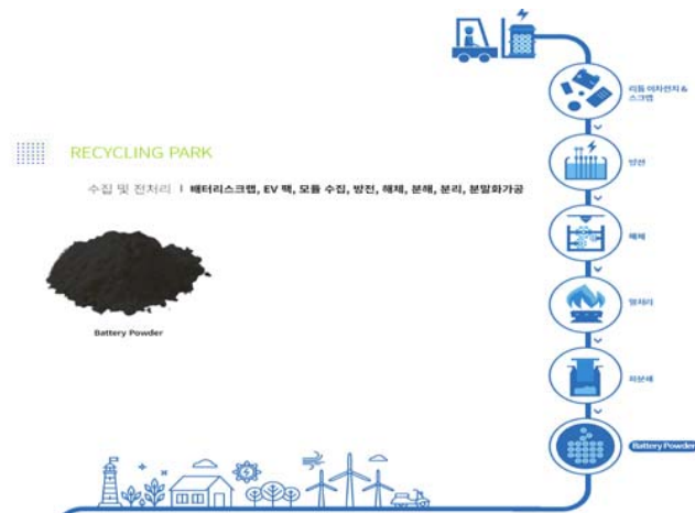
[그림 2-10] OO하이텍 리튬 이차전지 수집 및 전처리 과정(리사이클링 센터)
